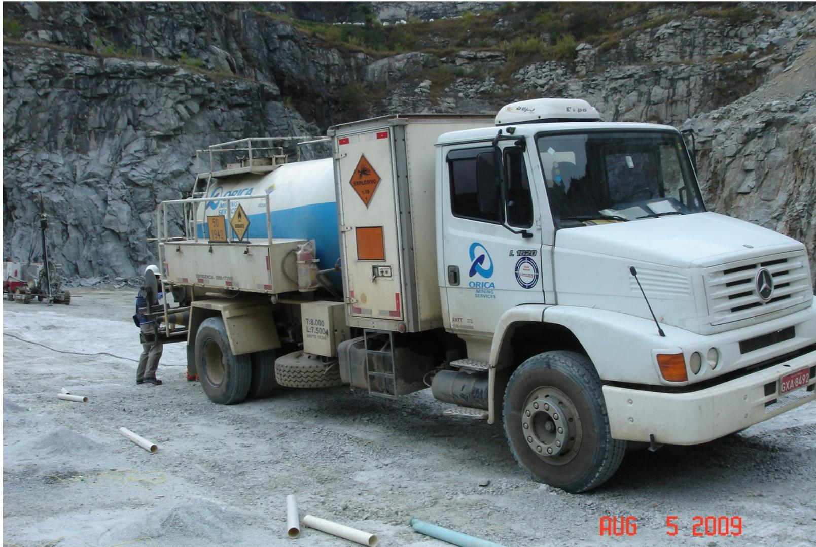
Camión especial que mezcla los productos que forman la emulsión Centra Gold. Al fondo se observa un equipo barrenador.
